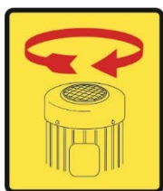
Obr. 4: Příklady: Šipka na krytu motoru při pravotočivém chodu
