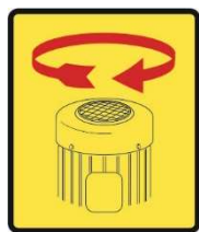
Abb. 4: Beispiele: Pfeil auf der Motorhaube bei Rechtslauf
