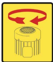
4. ábra: Példák: Nyíl a motor fedőjén jobbra forgás esetén
