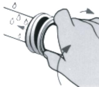
Montage du joint mécanique
